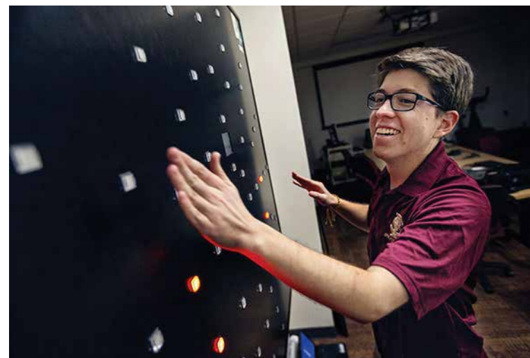
תמונה 1: אימון בביצוע מטלה כפולה בעזרת דינאוויזיון (DynaVision D2). יש ללחוץ על הכפתורים המוארים באדום המהווים מטלה תנועתית, בעוד שבמסך הקטן במרכז המכשיר (בערך בגובה העיניים של המשתמש בתמונה) מופיעה מטלה קוגניטיבית כלשהי
