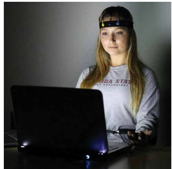
תמונה 4: סטודנטית מתאמנת בשימוש במערכת הביופיידבק. ניתן לראות את חיישני ה-EEG על המצח ואת חיישני המוליכות העורית והטמפרטורה על קצות האצבעות
