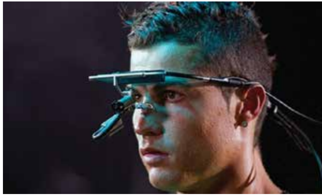
תמונה 3: טכנולוגיית מעקב העין על המשקפיים מורכבת מצלמה אחת שמתמקדת בעין ומצלמה אחרת שמופנית לסביבה. הטכנולוגיה מאפשרת לעקוב אחרי המבטים של שחקנים
